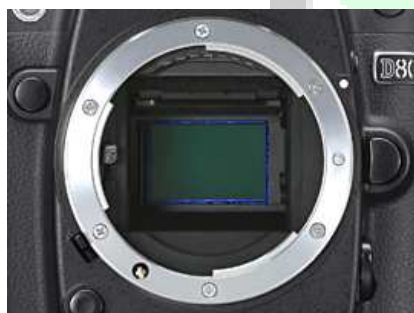
Le capteur CCD de 10.2 Mpixels du Nikon D80 caché derrière le miroir réflex. Dans ce cas-ci l'obturateur mécanique a été ouvert.
